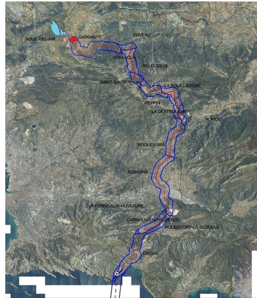
La canalisation de transfert des résidus vers la mer.
